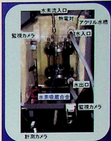
水素吸蔵合金の充填層膨張収縮実験装置
